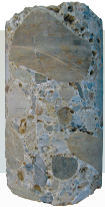
Bohrkern eines verkitteten Schotters (Bohrung Beichlen)
